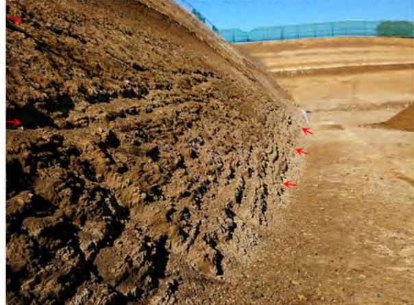
北露頭西面の小原台砂レキ層相当層の断層群(赤矢印)に伴うたわむような変形 2018年1月14日撮影
